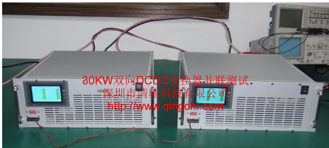
图二十一. 多台双向 DC-DC 模块并联运行
